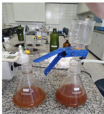
**Figura 5** – Filtração do extrato glicólico do pó da casca da banana verde em bomba de vácuo
